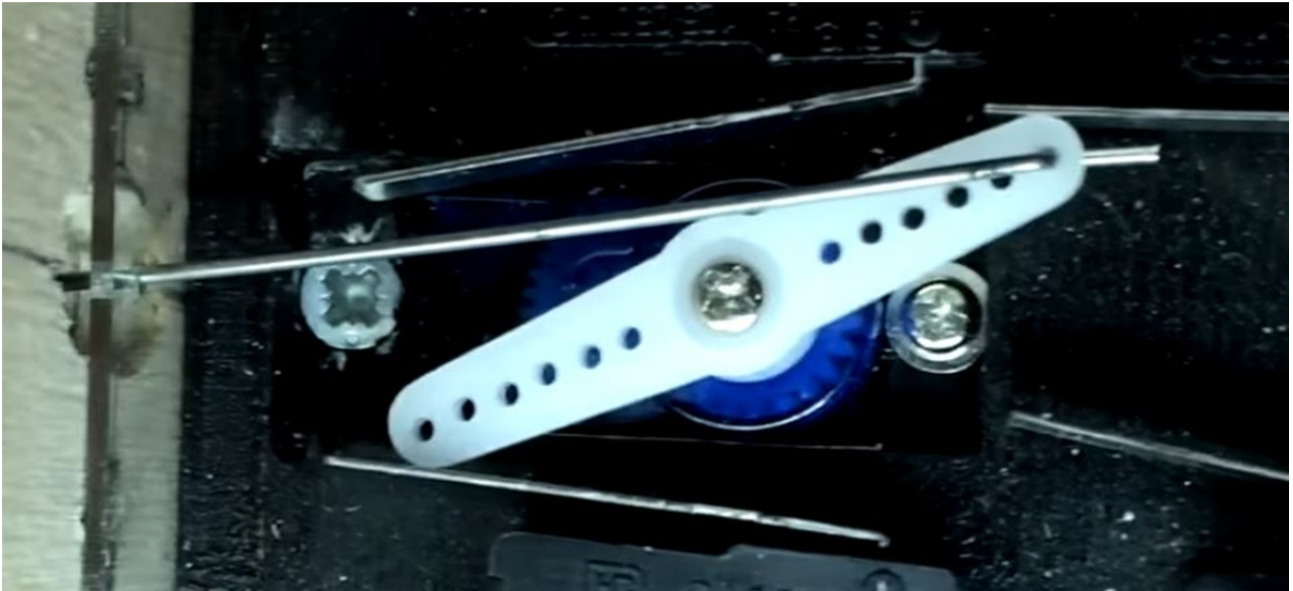
Movimento degli scambi con rinvio attraverso un fulcro preciso
