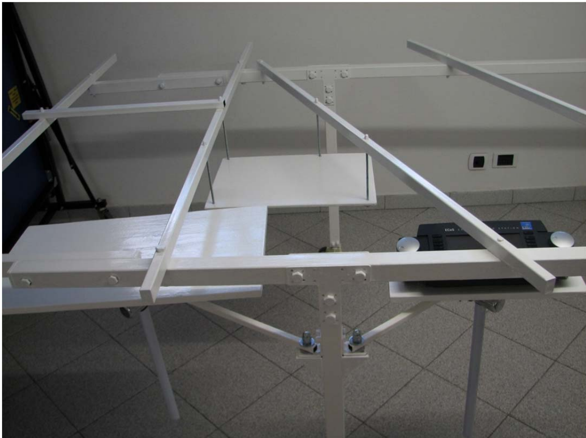
Ripiani per PC, Control Station e alimentatori / switch di rete sotto a struttura
