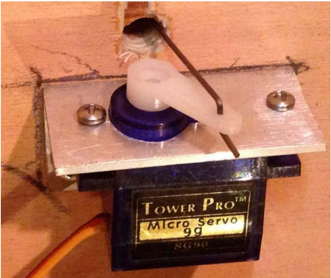
Movimento degli scambi con rinvio attraverso un fulcro non preciso
